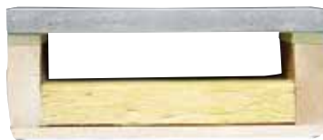
Plancher béton sur ossature bois
